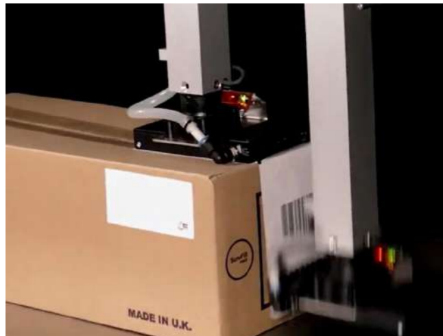
Perfekte Übereck-Kennzeichnung auch bei variierenden Produkthöhen.
