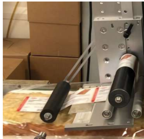
Schonende Kennzeichnung – z.B. für flexible Lebensmittelverpackungen.
