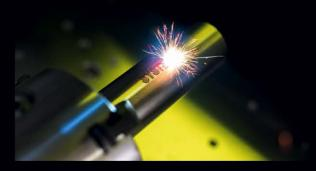
13 | DREHACHSE für die Markierung von zylindrisch geformten
