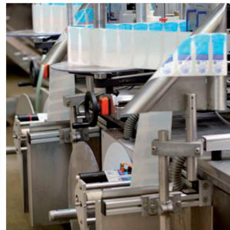
Etikett nochmals überprüft. Bei Unstimmigkeiten oder fehlendem Etikett wird das Produkt automatisch ausgeschleust.
