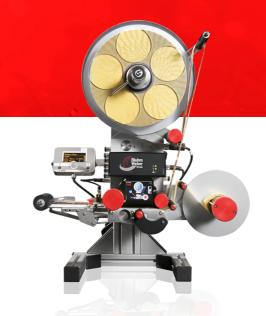
Mit Schutzklasse IP65 etikettiert die Alpha HSM auch zuverlässig in feuchten und staubigen Umgebungen - und das ohne separate Einhausung. Damit ist das System optimal für den Einsatz z.B. in der Chemieindustrie, Nahrungsmittelindustrie oder Baustoffbranche geeignet.
