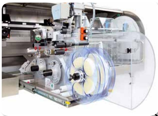
Der kompakte Siegeletikettierer lässt sich homogen in die Komplettanlage integrieren und ist leicht zugänglich.
