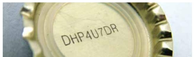
In einer **Sonder-Codiereinheit** für Kronkorken, Metall- und Kunststoffschraubverschlüsse oder auf Siegfelien lassen sich mit dem Faserlaser e-SolarMark FL interne Kennzeichnungen, Gewinnspielcodes, Zusatzinformationen etc. aufbringen.
