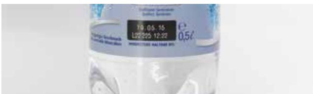
Dünne und empfindliche Getränke-Sleeves lassen sich schonend mit dem **Faserlaser e-SolarMark CFL** beschriften, der mit einer anderen Laserquelle und Strahlsteuerung (Continuous Wave statt gepulst) arbeitet. Mit einer Lebensdauer von üblicherweise über 100.000 Betriebsstunden arbeitet er sehr rentabel. Die Faserlaser-Optik ist wartungsfrei.
