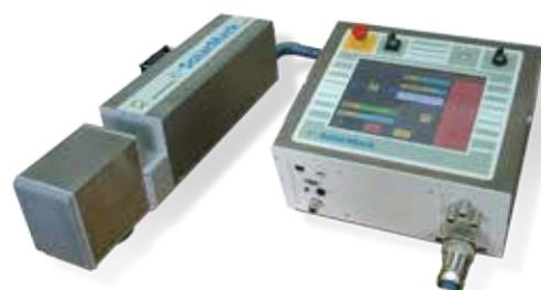
*Mit dem neuen, 20 Watt starken YAG-Laser e-SolarMark DLS steht ein bedienerfreundlicher Laser für zahlreiche Beschriftungsaufgaben zur Verfügung. Besonders geeignet ist der DLS für den Einsatz im Automotive-Bereich, wo es auf eine hohe Lesbarkeit der Markierungen für eine sichere Rückverfolgung der einzelnen Bauteile ankommt.*
