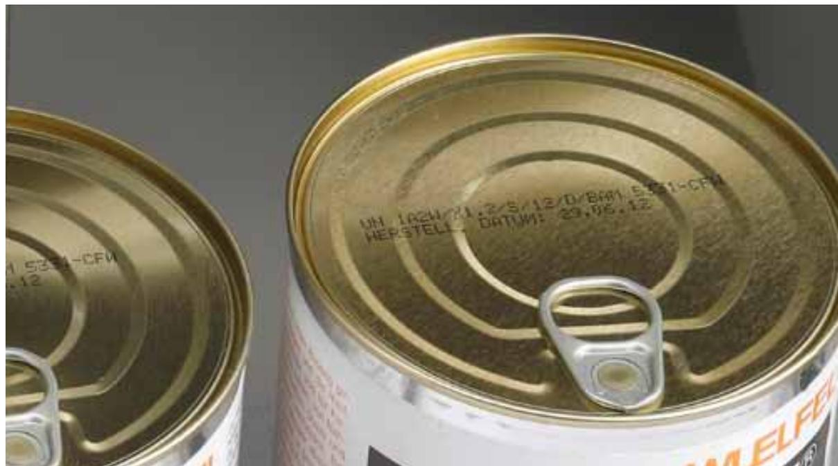
**3.000 Dosen pro Tag bedruckt der Linx 4900 bei der Chemischen Fabrik Wülfel. Doch sind höhere Taktraten möglich.**
