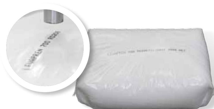
*Für die Bedruckung der flexiblen Säcke kommen Linx-Drucker zum Einsatz.*
