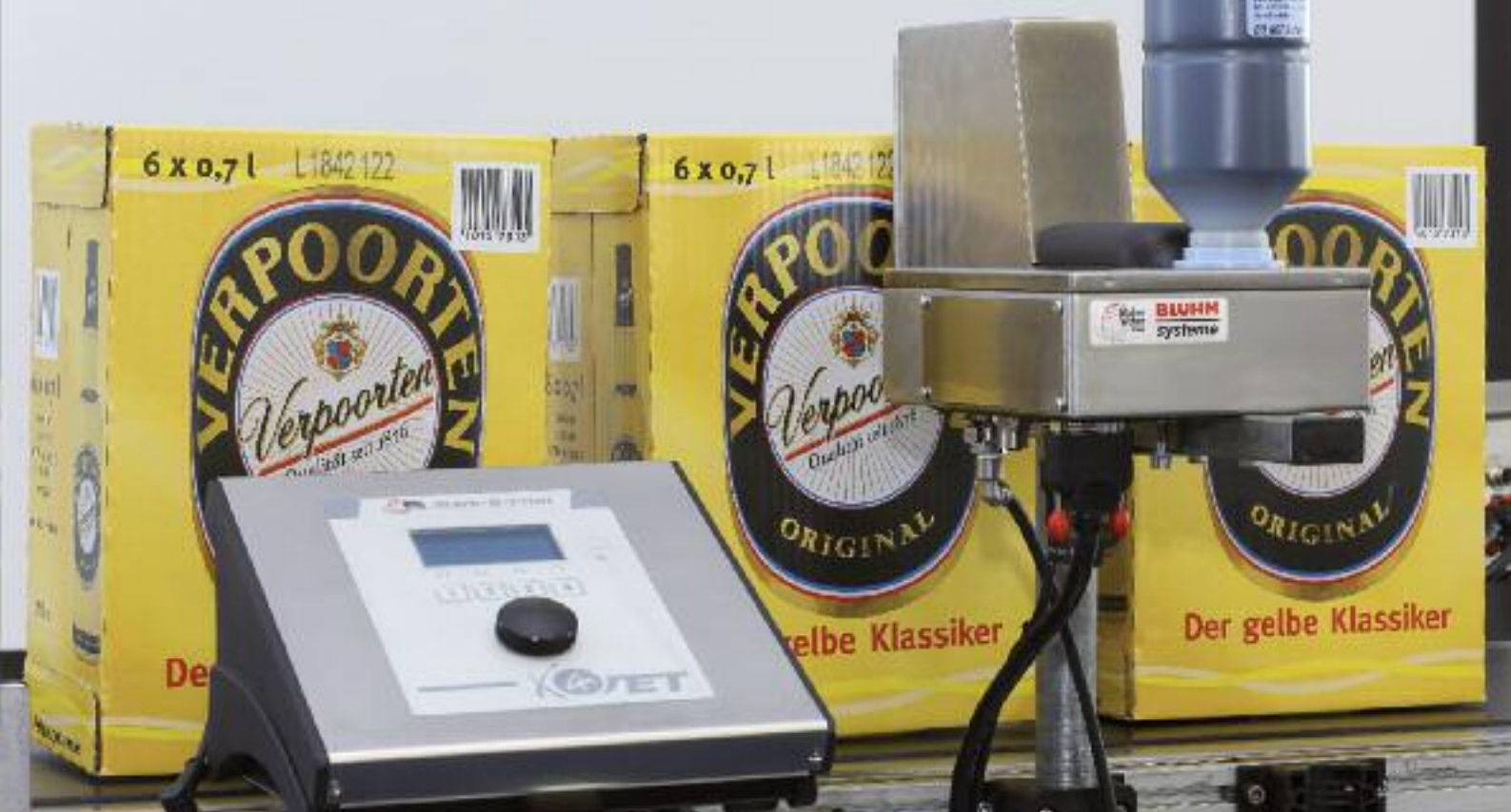
Bei Verpoorten druckt ein Markprint Tintenstrahl drucker mit Trident-Technologie Barcode, Produktbezeichnung und Chargennummer auf die Kartons.
