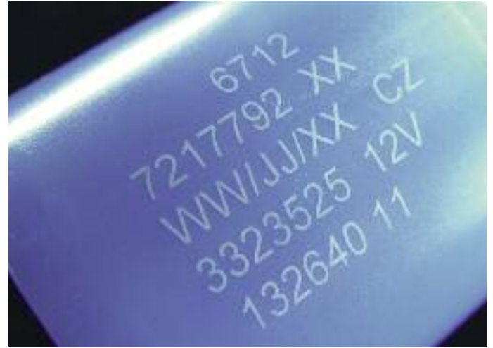
Lasercodierung auf Kunststoffbauteil
