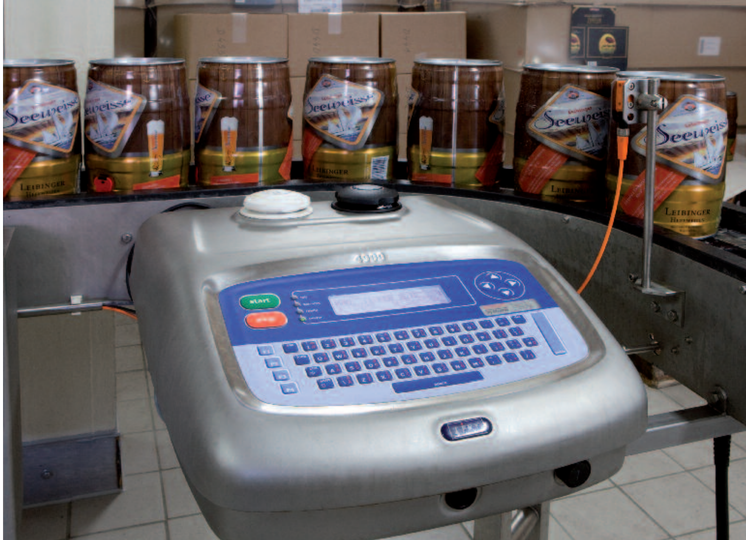
Der Linx 4900 beschriftet den konvexen Fassboden der 5-Partyfässer mit einem Mindesthaltbarkeitsdatum.
