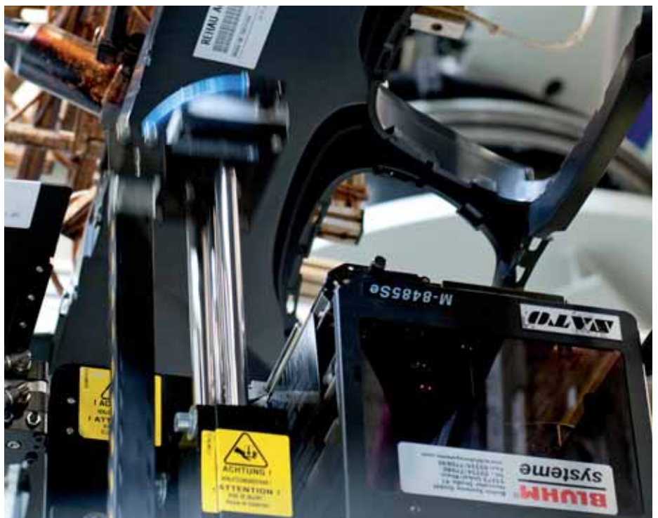
Bei Rehau bedruckt und beschreibt ein vollautomatischer RFID-Etikettendruckspender über Kopf die RFID-Labels mit entsprechenden Informationen und appliziert sie auf die Rohteile. Foto – Siemens AG
