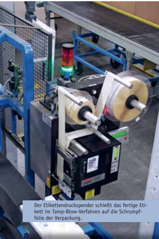
Das Etikett enthält die Information, dass die Verpackungseinheit optisch überprüft wurde, die Personalnummer des verantwortlichen Mitarbeiters sowie einen Code 39-Barcode.
