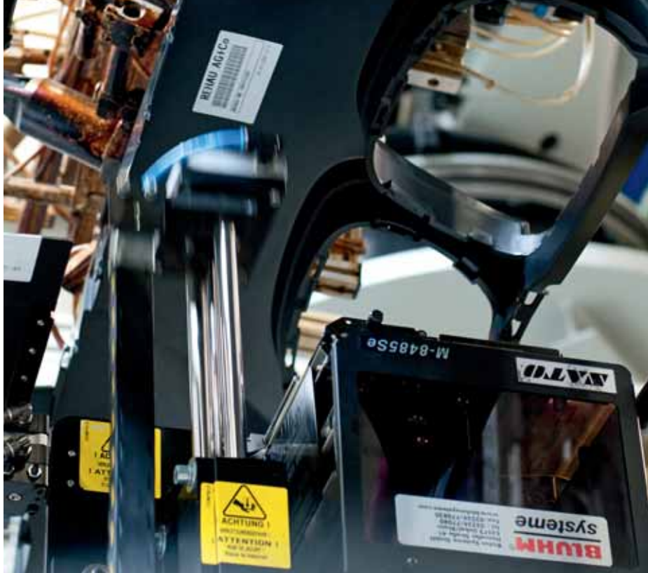
Ein vollautomatischer RFID-Etikettendruckspender bedruckt und beschreibt die RFID-Labels über Kopf mit entsprechenden Informationen und appliziert sie auf die Rohteile.
