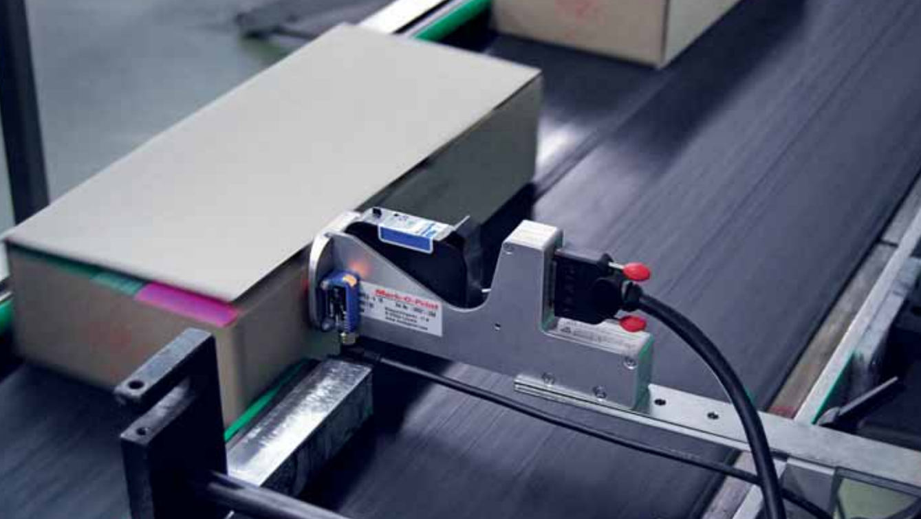
Charge und Haltbarkeitsinformation auf den Kartons werden mit Compactline 2.5-Codierern aufgebracht.
