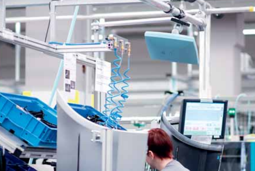
Auch die manuellen Bearbeitungsplätze sind vollständig mit RFID-Antennen ausgerüstet.
