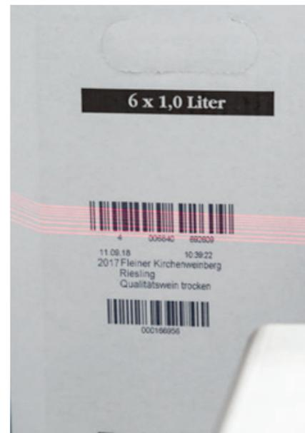
Thermische und Piezo-Inkjet-Drucksysteme bedrucken die unterschiedlich großen Kartonagen mit Informationen wie Wein- und Rebsorte, Abfülldatum und -ort, Inverkehrbringer und EAN18-Barcode.
